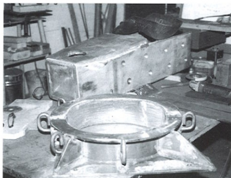
Ruderhacke und Mastbeschlag liegen zum Einbau bereit
