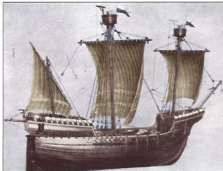
„Hansekogge“ nach dem Entwurf von Busley, 1919. Länge ü. A. = 28,60 m, Breite = 7,90 m, Tiefgang = 2,7 m, Wasserverdrängung = 240 t, Segelfläche = 290 qm
