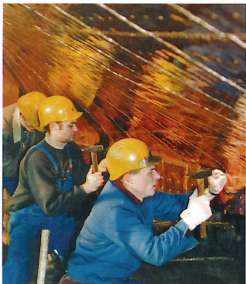
Der Rumpf wird mit Kupferblechen beschlagen
