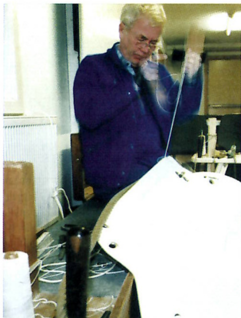
Das Liektau am Großsegel wird angenäht
