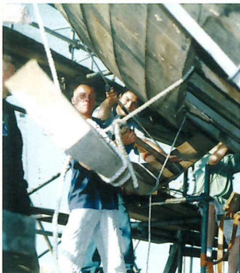
Eine Planke wird angebaut
