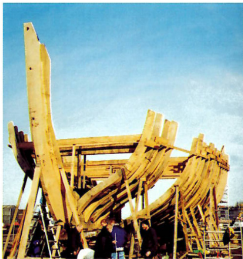
Der Vorsteven und einige Spanten sind aufgestellt
